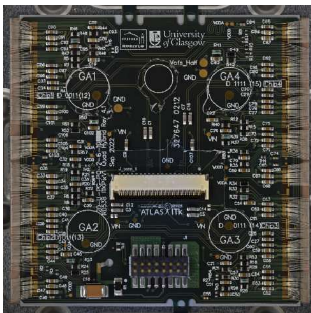
図 2.5: パリレンコーティング後のモジュール
