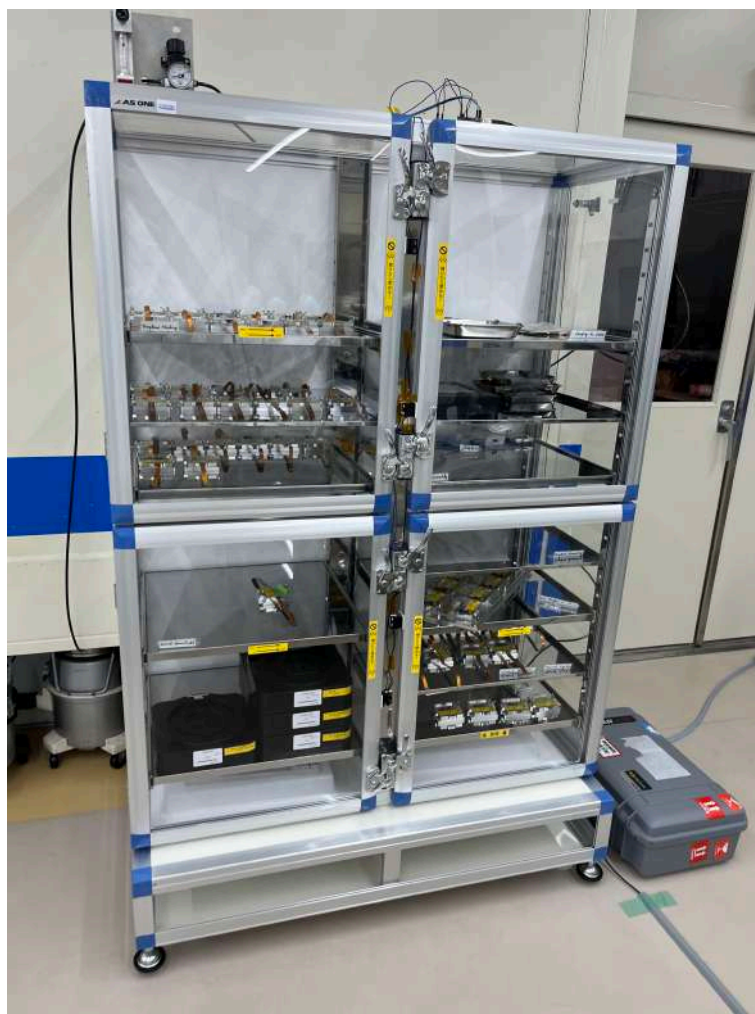
図 4.8: モジュール保管用デシケータ
