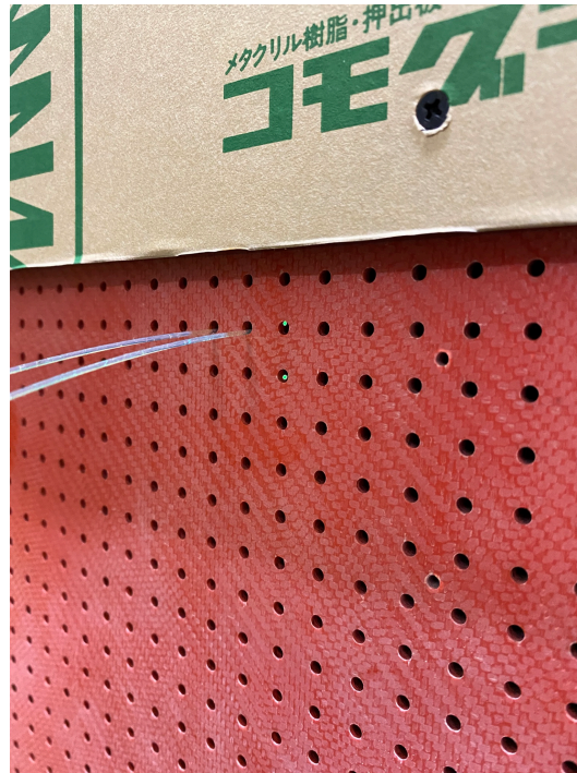
図 5.5 SuperFGD のガラスエポキシ (G10) 製の外壁の写真。波長変換ファイバーを通すための直径 3mm の穴が空けられている。LED の光はこの穴を通過し、ファイバーの端面で吸収される。
