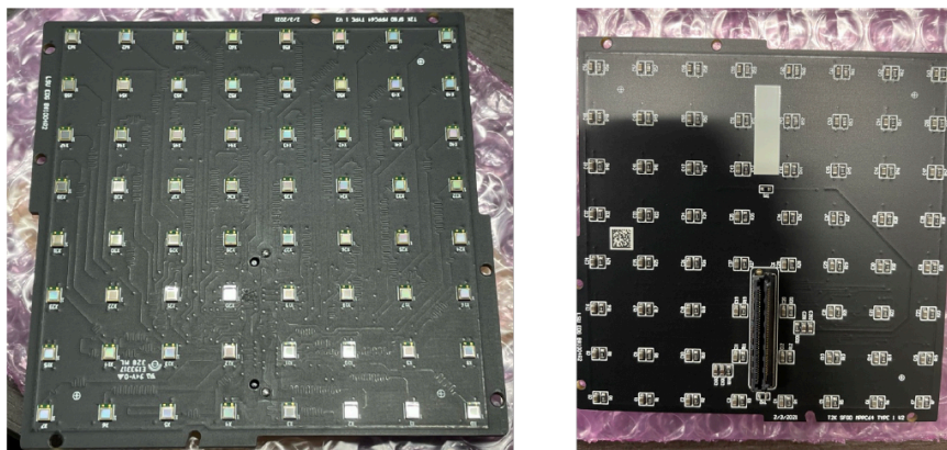
図 2.4 MPPC 基盤の写真 [14]。この基盤には 64 個の MPPC S13360-1325PE が表面実装されている。左が MPPC の受光面がある面、右がその裏面である。
