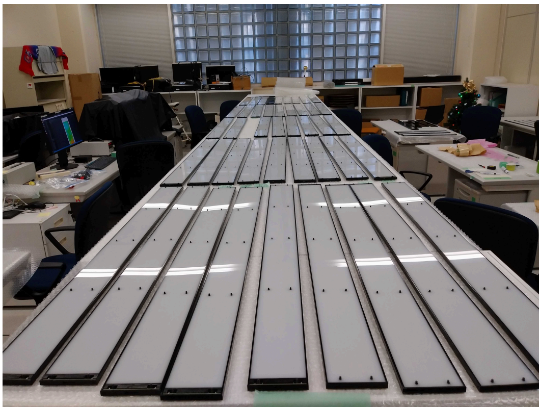
図 6.7 組み立て後の量産品の Bottom LGP モジュールの写真。
