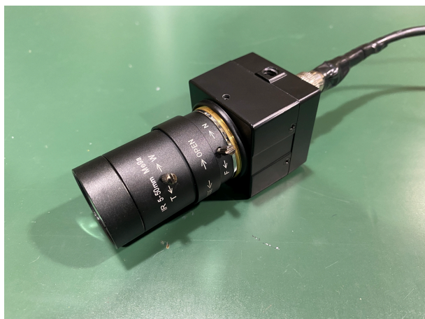
図 5.6 検査システムに用いるカメラ (ELP-USB8MP02G-SFV(5-50mm)) の外観。本検査システムでは同じ型番のカメラを 12 個用いる。
