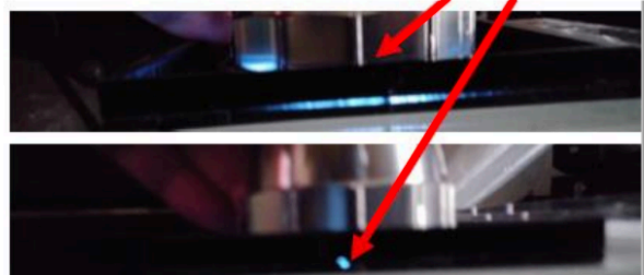
図 6.4 ライトを用いたケースの遮光の確認の様子。ケースの接合部に隙間がある場合、目視で確認できるほどの光漏れが確認できる。
