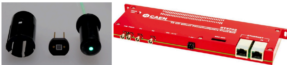
図 4.1 MPPC と波長変換ファイバーの写真 (左) と DT5702 の写真 (右)。左の中央が MPPC(S13360-1325CE)、その両側は波長変換ファイバーと光学接続のためのコネクタである。
