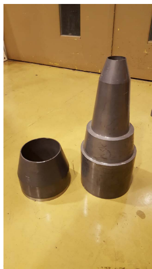
図 2.6 鉛シールドの外観。左は UNI II で使用された鉛シールド、右は UNI I および UNI III で使用された鉛シールド
