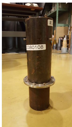
図 2.2 ガンマ線検出器の外観。光電子増倍管を上側、NaI(Tl) シンチレーターを下側にして置かれている
