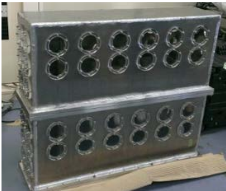
図 2.25: T3 チェンバーが2枚搭載できるガスコンテナ
