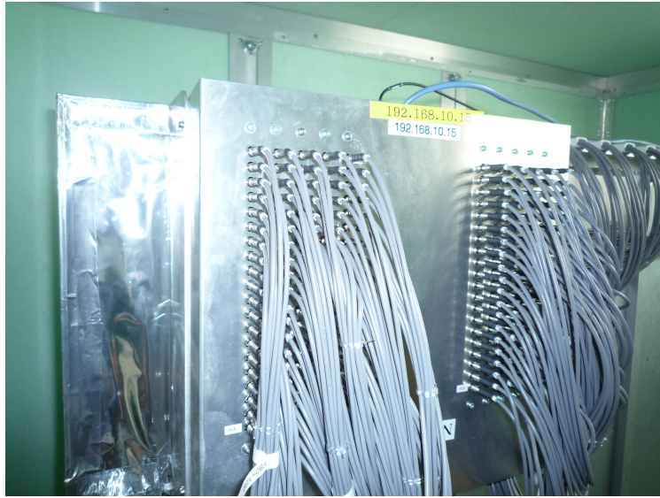
図 2.12: 検出器に接続された DAQ ボックス。X-Unit,Y-Unit にそれぞれ 100 本ずつの同軸ケーブルによって MPPC と接続されている。
