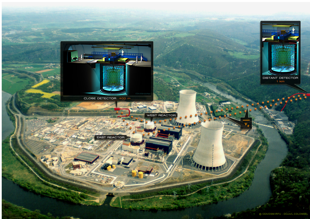
図 1.4 Chooz 原子炉と Double Chooz 検出器。図中の左側に示されているのが前置検出器、川を挟んだ右奥側が後置検出器である。右手の大きな建物は冷却設備で、原子炉は中央に 2 つ並んだ小さな丸い建物である。原子力発電所の周りは Meuse 川に囲まれている。
