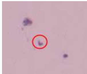
図 5.5: 電子顕微鏡で確認されたリーク電流増加サンプルの APD 表面。赤丸に示すように表面に物質が付着している様子がわかる。
