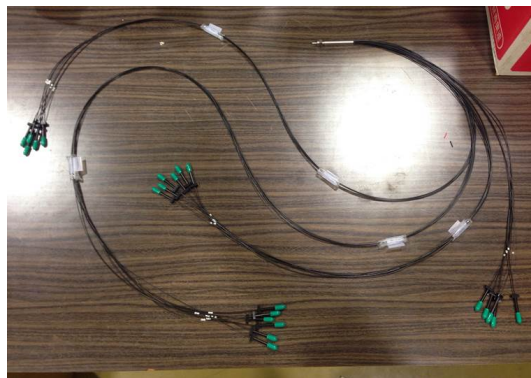
図 6.4: A-RICH モニターシステム用に開発された光ファイバー。従来のものよりも、照射窓の拡散範囲が広くなるよう設計された。
