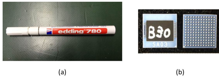
図 4.17: 耐熱ペン (a) と実際にシリアル番号を記述した様子 (b)。耐熱ペンの型番は
