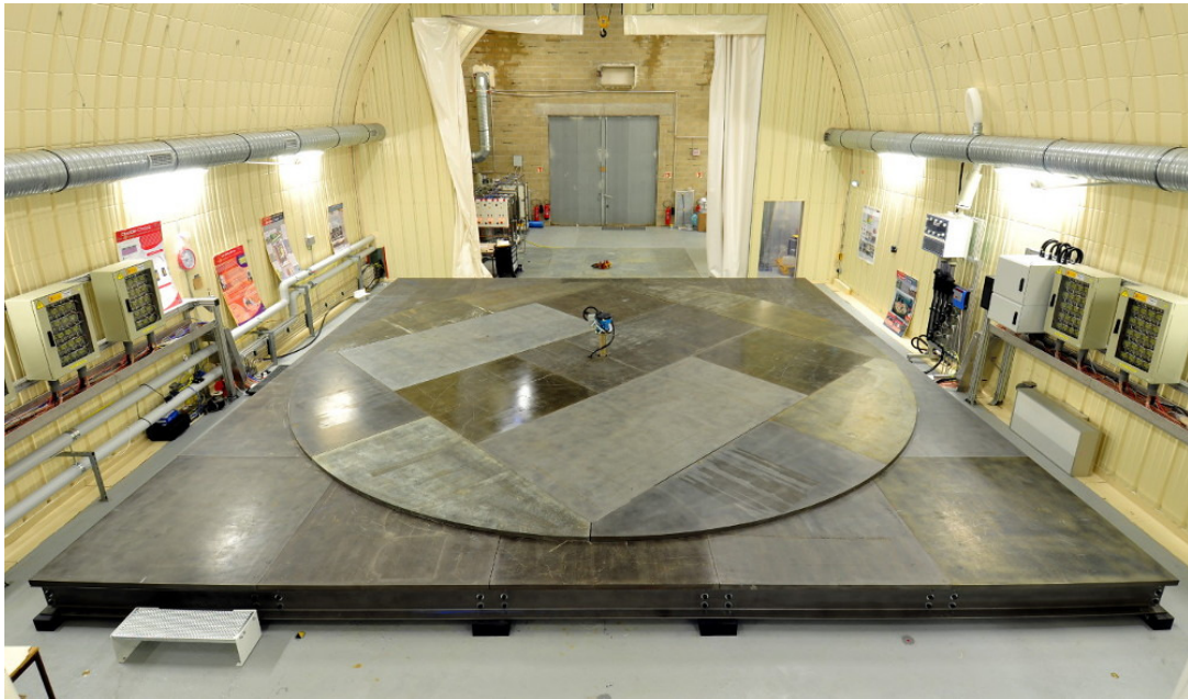
図 2.10 鉄シールドで遮蔽された前置検出器。
