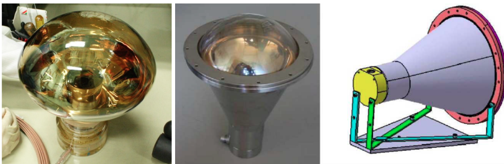
図 2.8 PMT の写真。左が ID 用 R7081、右が IV 用 R1048
