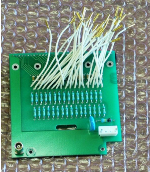
図 4.1: 高電圧分配ボード
