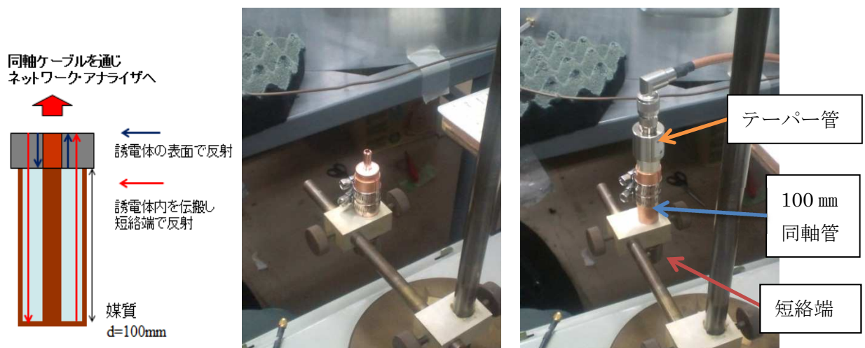
図 26 誘電体充填短絡端同軸管による岩塩誘電率測定
