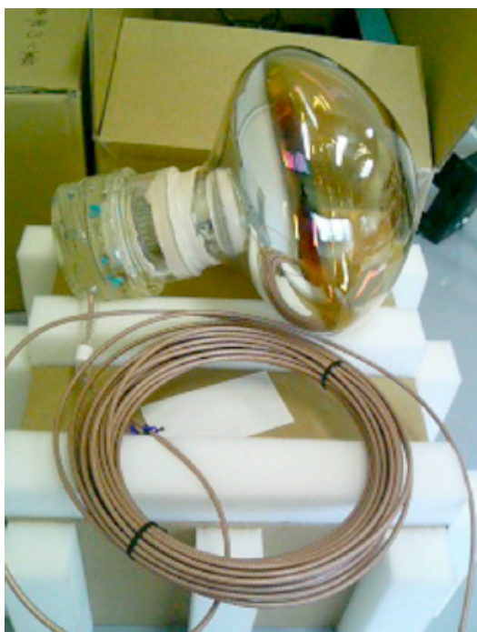
図 2.14: Inner Detector に使用されている 10 インチ光電子増倍管の写真
