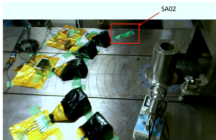
図 6.4: ガンマ線照射試験セットアップ, 名古屋大学 ^{60}\text{Co} 照射室で行った
