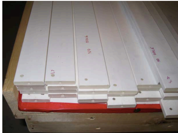
図 3.10: Outer veto シンチレータストリップ。これを 64 本並列に並べて 1 ユニットになる。
