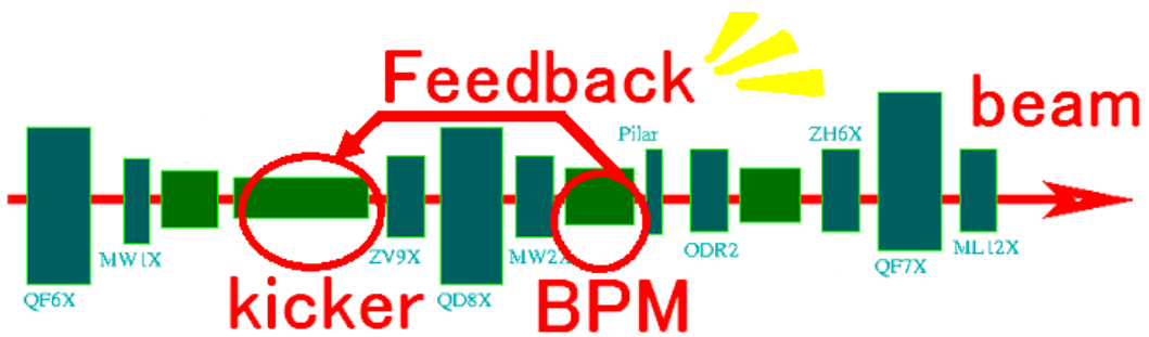
図 2.10: FEATHER 実験の kicker、BPM の設置の模式図。
