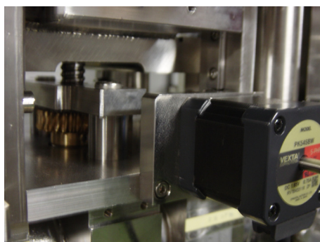
図 3.10: モータ、ギア、ボールねじ部分の写真。
